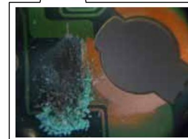
フェノールを含浸したと塗工紙を何枚か重ねて基材とするが、両側の1枚は黒の着色をしてある。基材の外観が黒くなり、黒SRの塗布を省略している。
