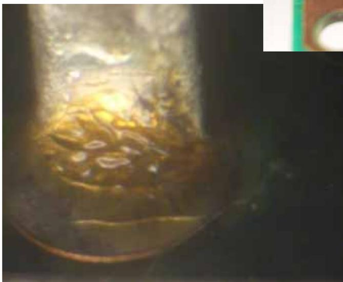
有識者に意見を求めたところ、これは発熱した箇所に見られるフラックス残渣の特徴であり、これが更に進行すると凹んだ残渣が亀裂を起こし、内部からはんだが盛り上がってくるとのこと。はんだ付け界面の合金層が成長し、更に発熱しやすくなり、やがて、熔融・発火の原因になり、注意が必要とのこと。放熱手段が甘いということになる。
